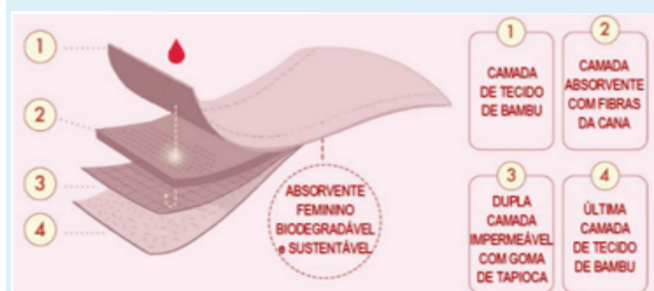
Figura 2 - Composição do absorvente produzido com bagaço de cana produzido pela turma de iniciação científica do "Garcia". (FONTE: Registro dos autores do projeto.)
